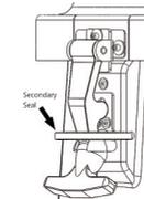
Die Gummiverriegelungskonstruktion ermöglicht die Verwendung eines Kabelbinders, Sicherheitssiegels usw., damit das Produkt unversehrt transportiert werden kann.
