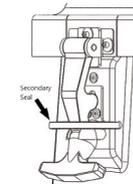
Il design della chiusura in gomma consente l'uso di una fascetta metallica, tenuta a umido, tenuta di sicurezza, ecc. per assicurare l'integrità del prodotto spedito.
