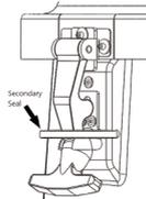
O fecho de borracha permite o uso de uma braçadeira plástica, lacre de segurança, etc. para assegurar a integridade do produto transportado.
