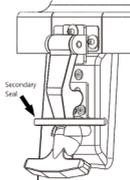
La conception du loquet en caoutchouc permet l'utilisation d'un serre-câble, d'un sceau vétérinaire, d'un sceau de sécurité, etc. pour garantir l'intégrité du produit expédié.
