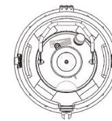
La schiuma ammortizzante in PPSC aiuta a impedire i danni al dewar. L'illustrazione mostra una vista dall'alto del serbatoio in PPSC.
