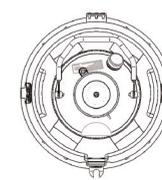
Stoßdämpfender Schaum im Transportbehälter aus Kunststoff verhindert Beschädigungen am Dewargefäß. Die Abbildung zeigt die Draufsicht auf den Transportbehälter.
